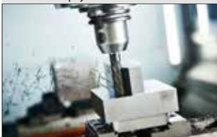
Fresado de apoyos laterales
