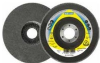
Klingspor: il disco in tessuto-non tessuto NUT3500 per la finitura dei cordoni di saldatura in acciaio inossidabile è acquistabile in 4 gradi di finezza, adatti a partire dalla fase di sgrassatura a quella di lucidatura
